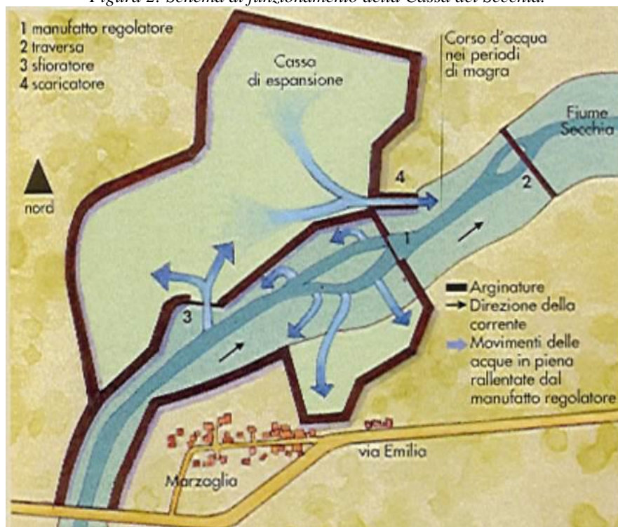
Figura 2: Schema di funzionamento della Cassa del Secchia.
